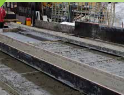
▲ Herstellung im Fertigteilwerk mit einbetonierter HDPE-Betonschutzplatte
